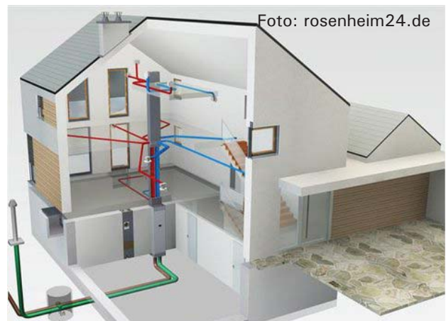
Schema einer Wohnraum-Komfortlüftung
